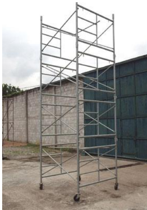
Andaimes Simplesmente Apoiados
